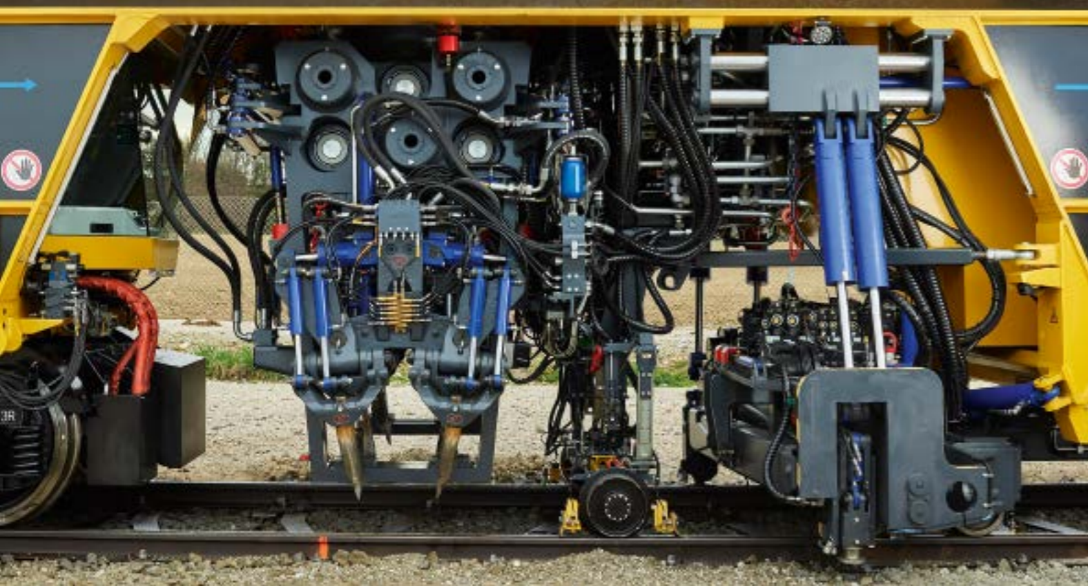
» Herzstück der mit über 20 Patenten ausgezeichneten Maschine ist das Flüster-Stopfaggregat mit vollhydraulischem Antrieb. » The core of the machine, which has been awarded 20 different patents, is the low-noise tamping assembly with its fully hydraulic drive.
